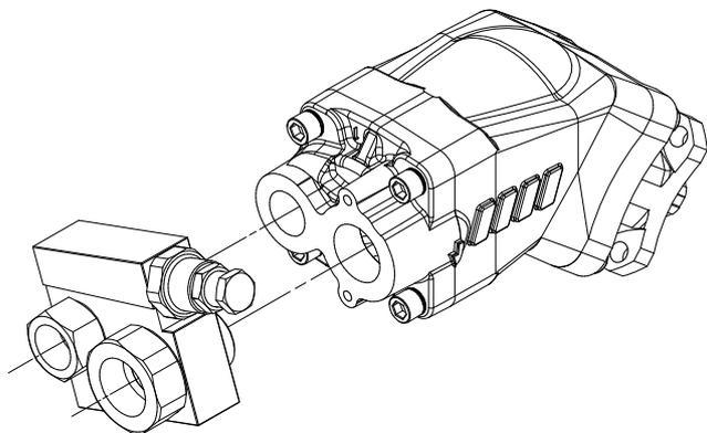
Il fissaggio della valvola sulla pompa è **simmetrico**, quindi è possibile **ruotarla di 180°** in modo da evitare possibili interferenze sul veicolo.
